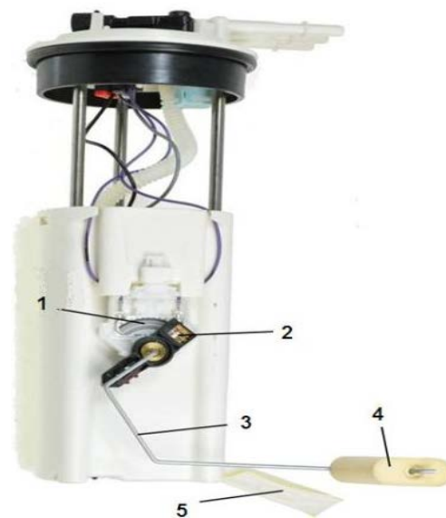
Рис. 1 Пристрій датчика рівня палива важільного типу: 1 – потенціометр; 2 – рухливий контакт бігунок; 3 – металевий важіль; 4 – поплавок; 5 – паливо вловлювач.
