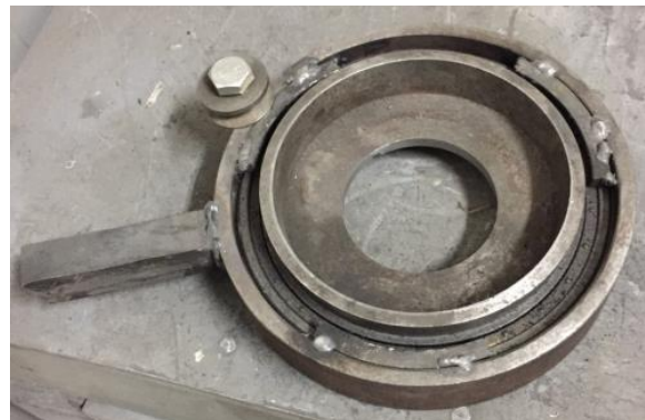
Рис. 3 – Формувальний інструмент для навивання спіралей шнеків обертовою втулкою: а) оправа; б) обертова втулка
