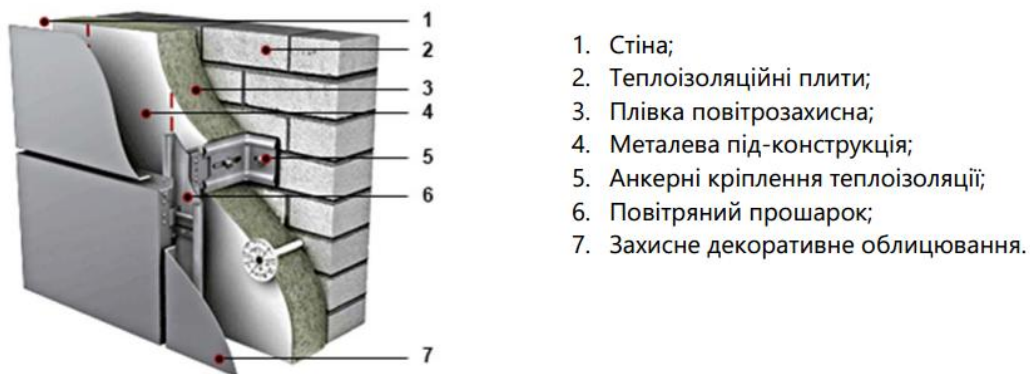
Рисунок 2 – Метод вентиляованого фасаду
