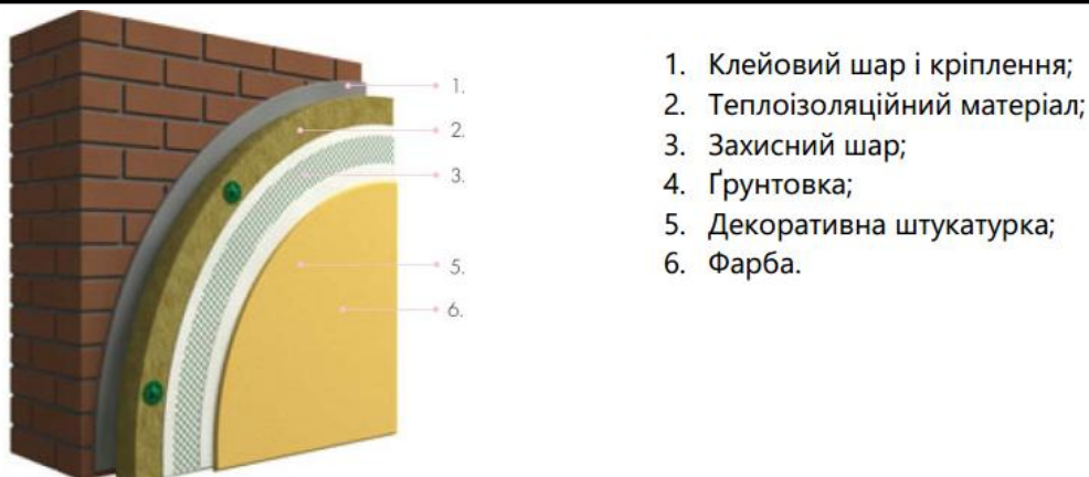
Рисунок 1 – Метод скріпленої теплової ізоляції
