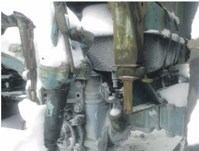
Бак покритий інеєм не тільки зовні, а і всередині. Оце і є та вода, що виведе паливну апаратуру дизеля з ладу
