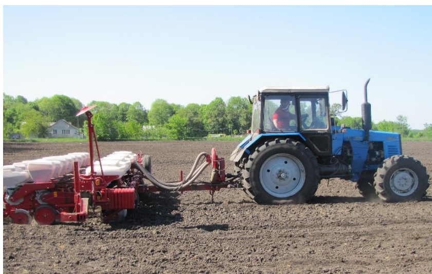
Рис. 1 - Агрегат для сумісних посівів кукурудзи та сої в складі трактора «Білорус» 1221.2. та сівалки «Vega-8 Profi»
