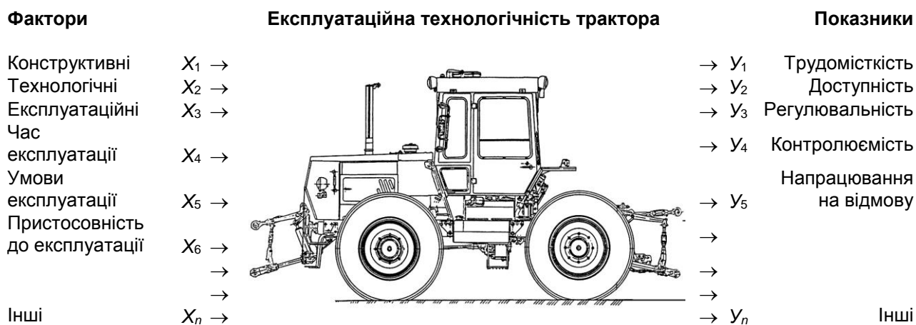
Рис. 1 – Функціональна модель формування показників експлуатаційної технологічності трактора
