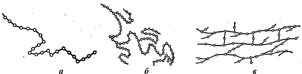
Рисунок 8.1 – Будова макромолекул полімерів: а – лінійна; б – розгалужена; в – просторова.
