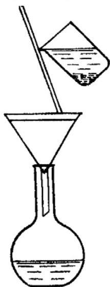
Рисунок 6.9 – Фільтрування розчину оцтової кислоти, що містить вугілля
