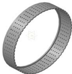
Рисунок 2 - Робочі колеса дезінтегратора: 1 - робочі диски; 2 - робочі кільця
