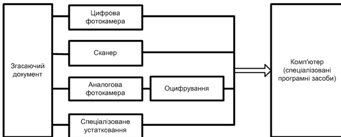
Рис. 1. Схема переведення згасаючого документа в електронний вигляд
