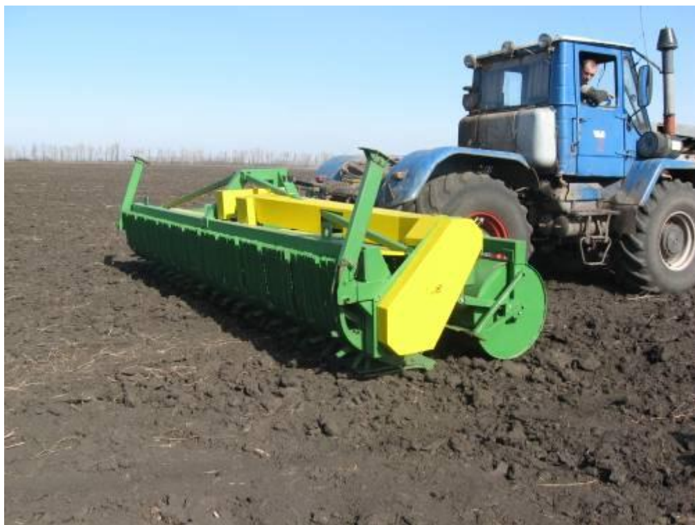
Рис. 4 – Машина для обработки поверхностного слоя почвы (КПР-5)
