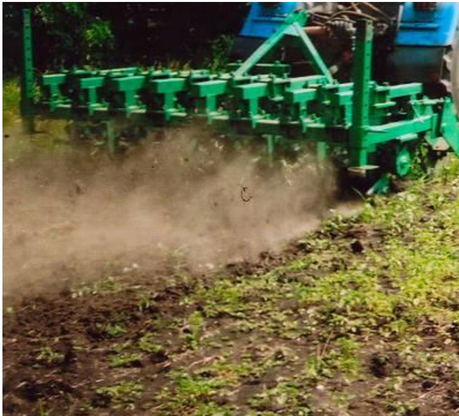
Рис. 3 – Машина для обработки поверхностного слоя почвы (КПП-3,2)
