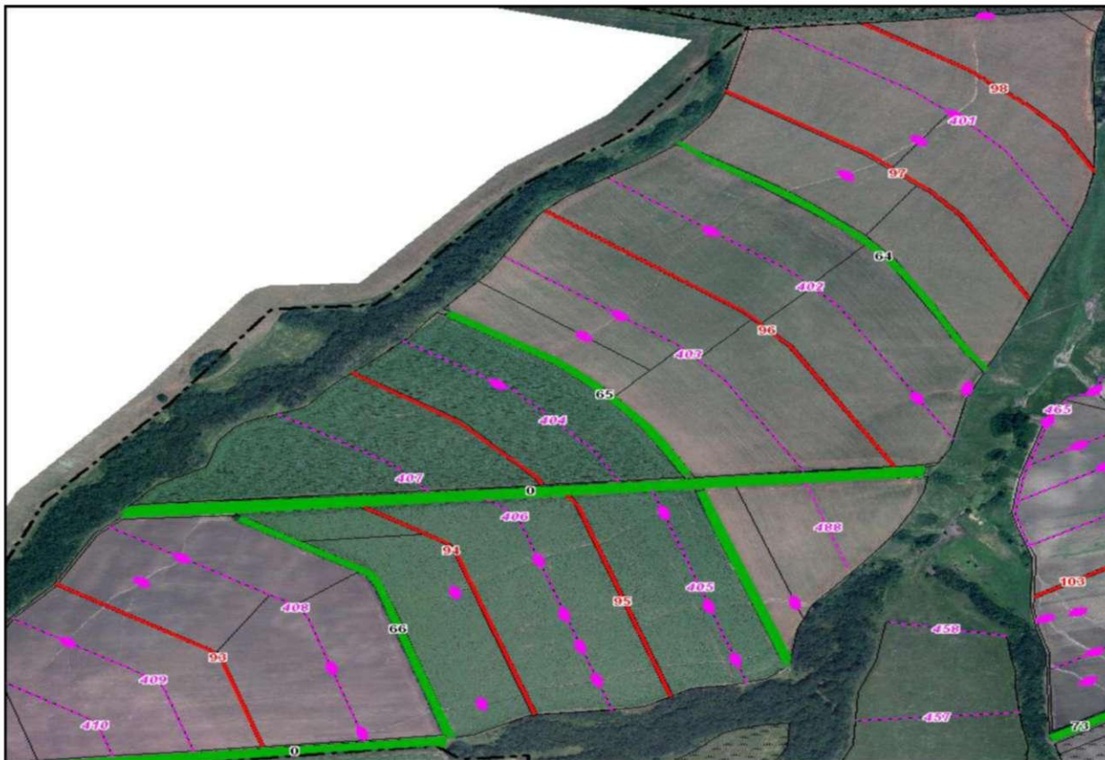
Рис. 3. Схема можливого розміщення мулофільтрів на довгому схилі розсіюючого типу північно-східної експозиції з базисом ерозії 100 м південно-західної частини території колишнього ДГ «Ударник»
