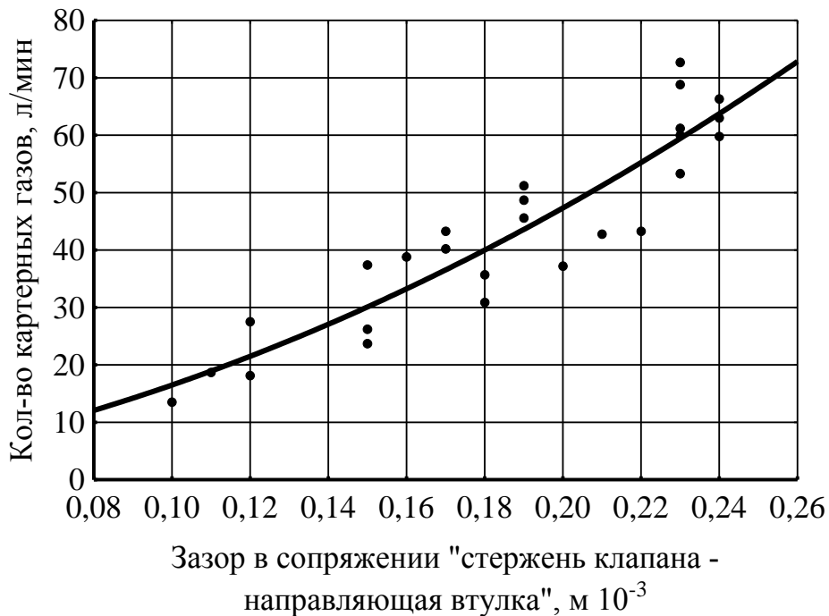
Рис. 2 – Зависимость между износом узла «стержень клапана – направляющая втулка» и количеством картерных газов
