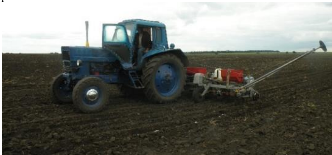
Рис. 3 – Внутрпочвенное внесение гербицидов в слое пены
