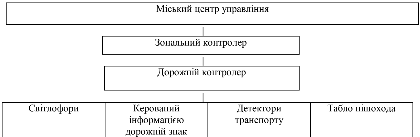
Рис. 1 – Ієрархічна будова автоматичної системи управління
