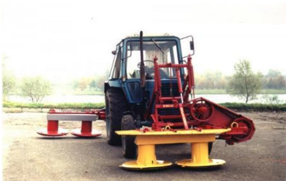
Рис. 5 – Роторні косарки з верхнім приводом різальних апаратів
