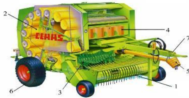
Рис. 11 – Прес - підбирачі для формування паків циліндричної форми з подрібнювачем
