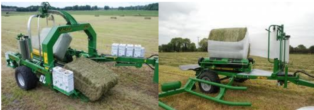
Рис. 12 – Обмотування паків прямокутної та циліндричної форми плівкою
