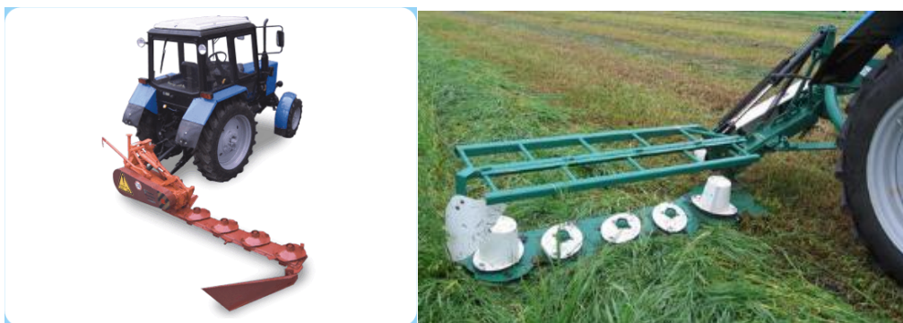
Рис. 2 – Роторні косарки з нижнім приводом різальних апаратів
