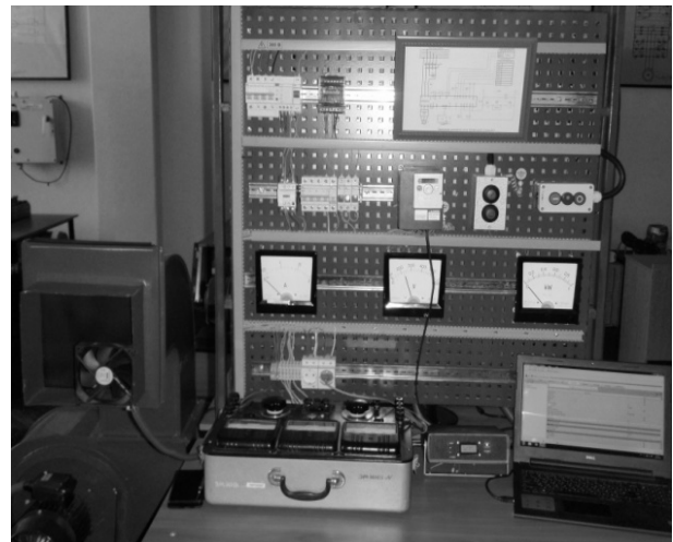
Рисунок 1 – Лабораторний стенд для дослідження роботи частотно-керованого асинхронного електроприводу вентиляційної установки
