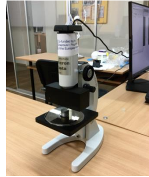
Рисунок 2 – Оброблюваний циліндр з пробкою-«свідетелем» (а), профілограф-профілометр з пробкою на об'єктному столику (б)
