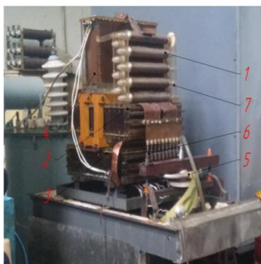
Рис. 1. Установа для електроімпульсної обробки продуктів: 1 - багатозазорний розрядник; 2, 3, 4 - високовольтні конденсатори; 5 - робоча камера; 6 - металеві шпильки; 7 – захисний екран
