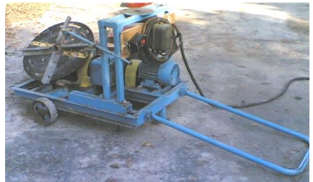
Рис. 1. Загальний вигляд експериментальної установки для дослідження процесу внесення мінеральних добрив відцентровими дисковим тукорозсівним робочим органом, осі якого установлені похило
