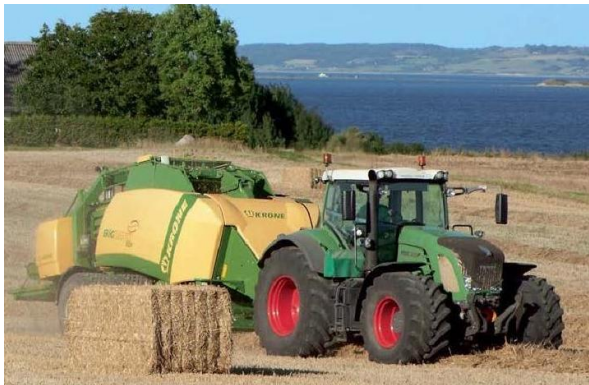
Рис. 2. Комбінований збиральний агрегат з активними робочими органами на базі трактора Fendt 920 Vario та прес-підбирача Krone Big Pack 1290 ХС.
