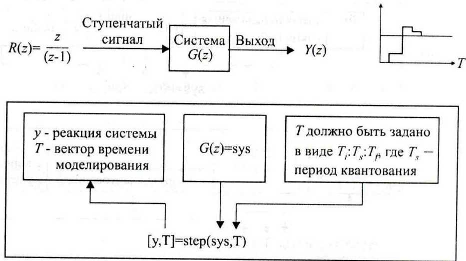
Рисунок 1.4 – Використання функції step для визначення реакції системи y(kT) на одиничний ступінчатий сигнал
