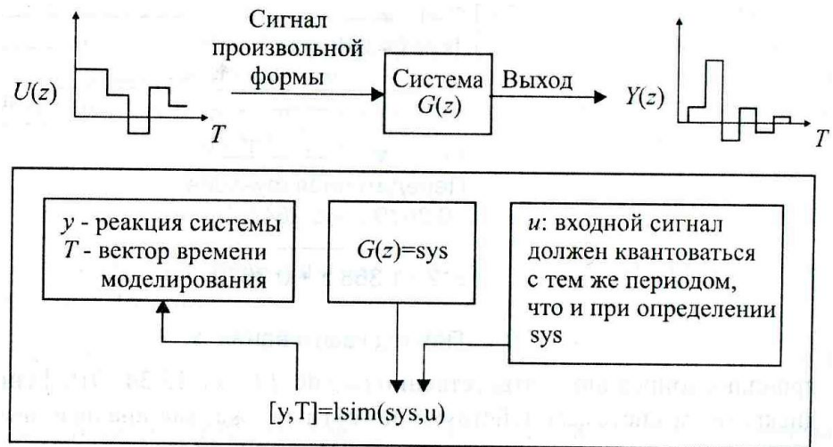
Рисунок 1.6 – Використання функції lsim для визначення реакції системи y(kT) на сигнал довільного виду
