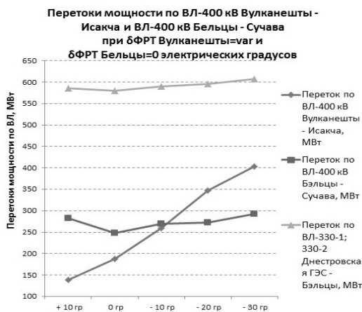
Рисунок 5 – Перетоки мощности по ВЛ-400 кВ Вулканешты – Исакача и ВЛ-400 кВ Бельцы – Сучава при \delta ФРТ Вулканешты = var и \delta ФРТ Бельцы = 0 электрических градусов
