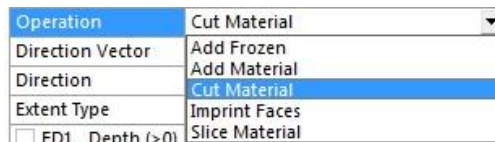
Рис. 4. Опції видалення матеріалу Cut в команді Extrude
