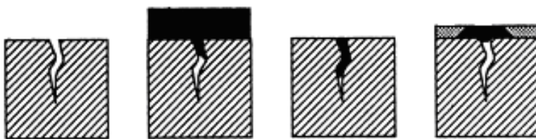
Рідинний (капілярний) метод дефектоскопії Liquid (capillary) method of flaw detector
