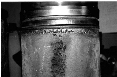
Кавітаційне зношування Cavitation wear
