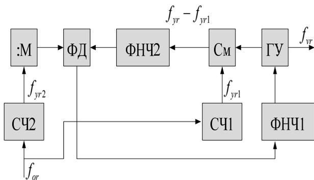
Рисунок 10 – Структурная схема трехкольцевого синтезатора частоты
