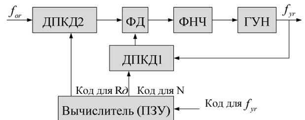
Рисунок 8 – Структурная схема синтезатора с аппроксимацией значений выходных частот
