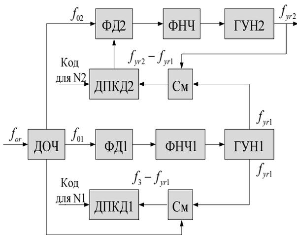
Рисунок 9 – Структурная схема двухкольцевого синтезатора частоты
