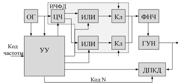
Рисунок 4 - Структурная схема СЧ с ИЧФД
