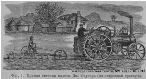
Земледельческая газета, №1 від 12.10. 1913 Фиг. 1. Прямая система пахоты Дж. Фаулера (по старинной гравюре).
