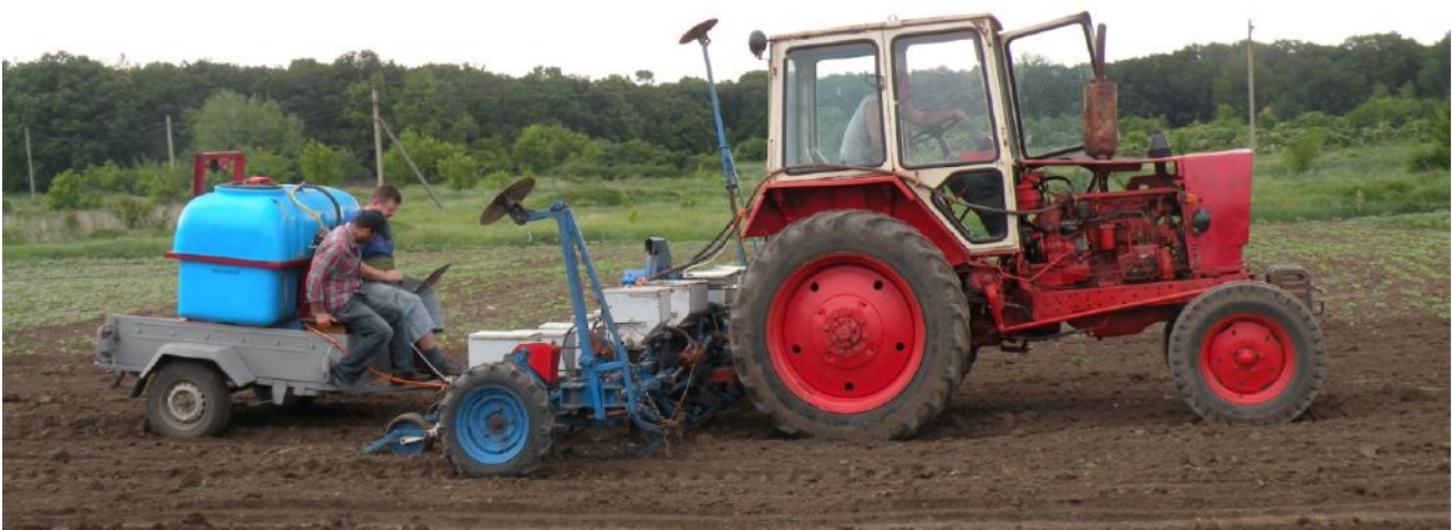
Рис. 9 – Комбінований агрегат для одночасного виконання посіву просапних культур і стрічкового внутрішньогрунтового внесення гербіцидів
