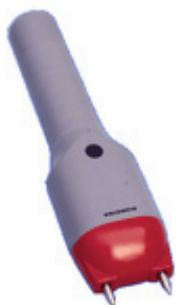
Рис. 9.2. Пристрій для електрооглушення (модель KAWE 21)
