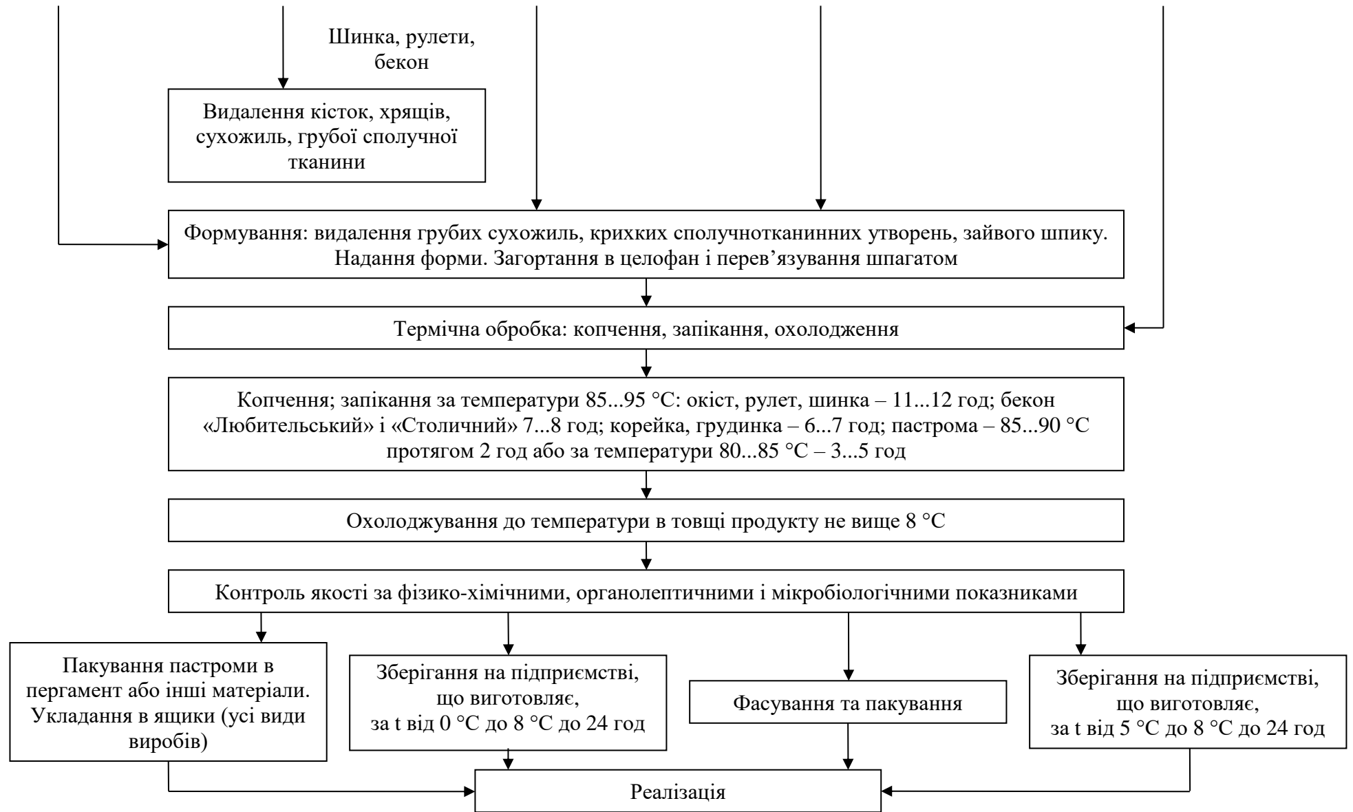
Рисунок 1.20 – Технологічна схема виробництва продуктів зі свинини
