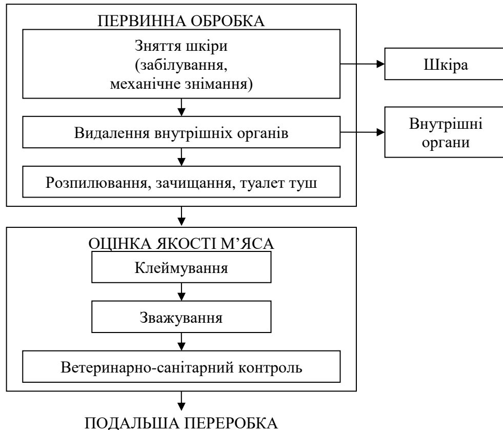
Рисунок 1.7 – Принципова схема первинної переробки туш забійних тварин
