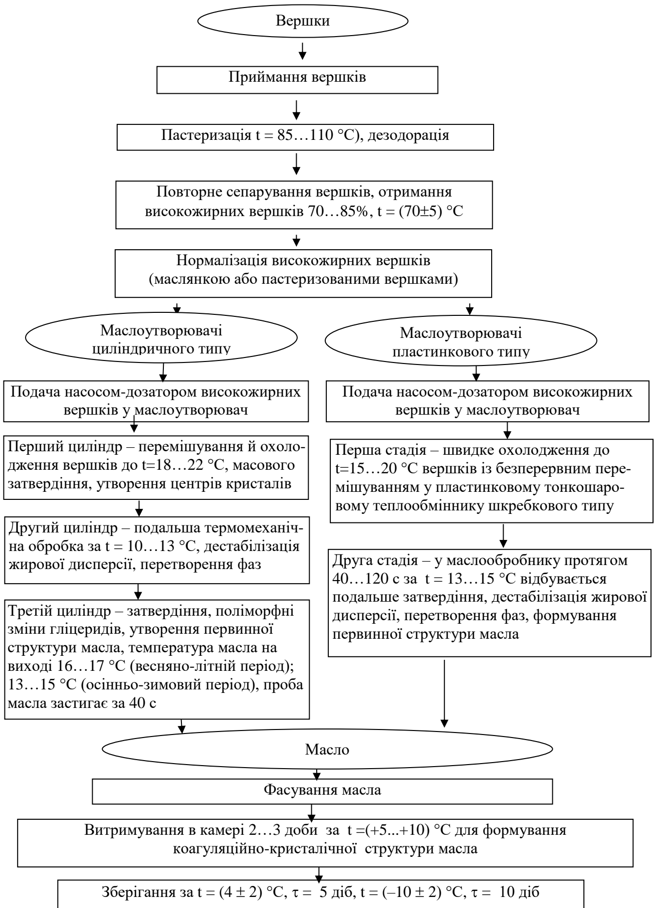
Рисунок 3.25 – Технологічна схема виробництва масла перетворенням високожирних вершків
