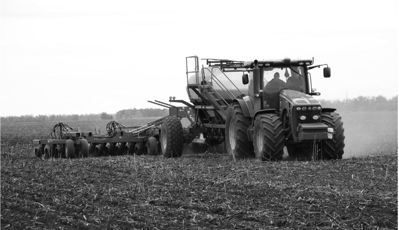
Рис. 7.1. Комбінований ґрунтообробно-посівний агрегат в складі трактора John Deere 8345R, бункера John Deere 1910 та сівалки прямої сівби John Deere 1895
