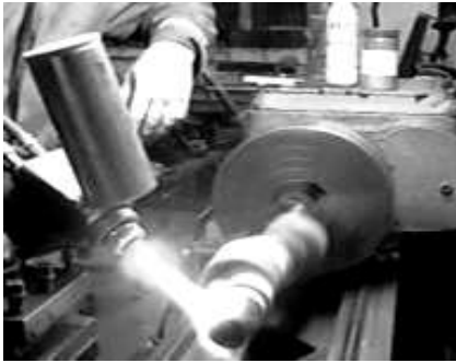
Газотермічне напилювання Hot spraying
