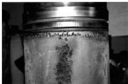
Кавітаційне зношування Cavitation wear
