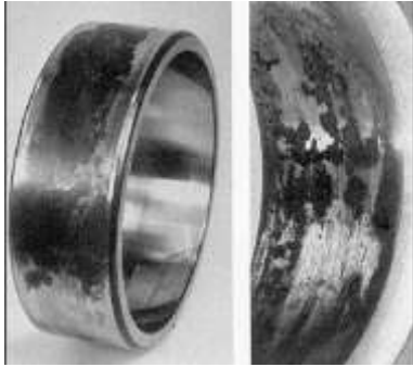
Фретінгове зношування Fretting wear
