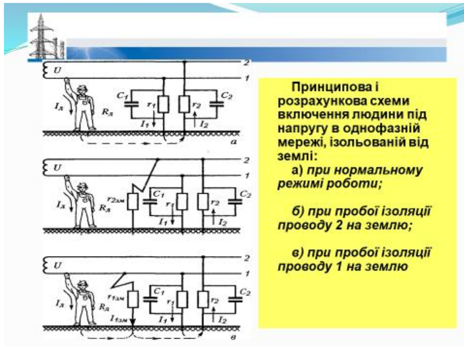
Рисунок 43. Принципова і розрахункова схеми включення людини під напругу в однофазній мережі, ізольованій від землі
