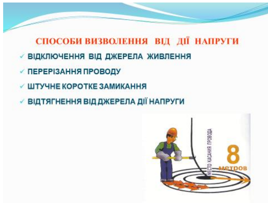
Рисунок 44. Способи визволення від дії напруги
