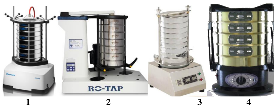
Рисунок 14.11 – Лабораторні просіювальні машини: 1 – просіювальна машина Retsch AS450; 2 – просіювальна машина RO-TAP Sieve Shaker; 3 – просіювальна машина типу IEL200; 4 – лабораторне вібросито Meinzer II
