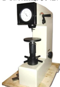
Рисунок 39.5– Твердомір Роквелла по металу
