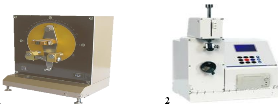
Рисунок 33.4– Прилади для визначення: 1 – опору вигинання паперу й картону (за ISO 2493); 2 – міцності на злам за багаторазової перегинання – метод МІТ (за ISO 5626)
