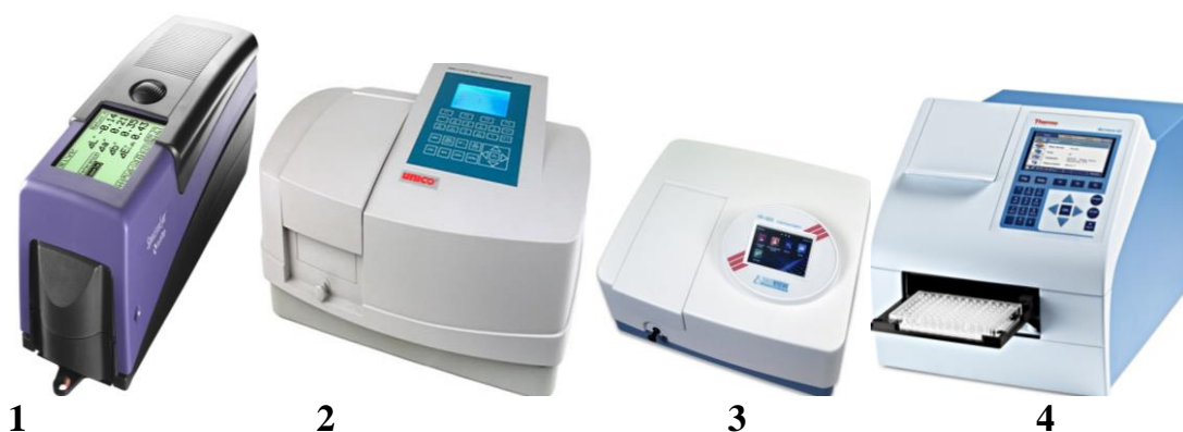
Рисунок 12.8 – Спектрофотометричні прилади: 1 – спектрофотометр X-Rite; 2 – спектрофотометр ЮНИКО 2800; 3 – спектрофотометр УФ-1800; 4 – планшетний спектрофотометр Multiscan GO
