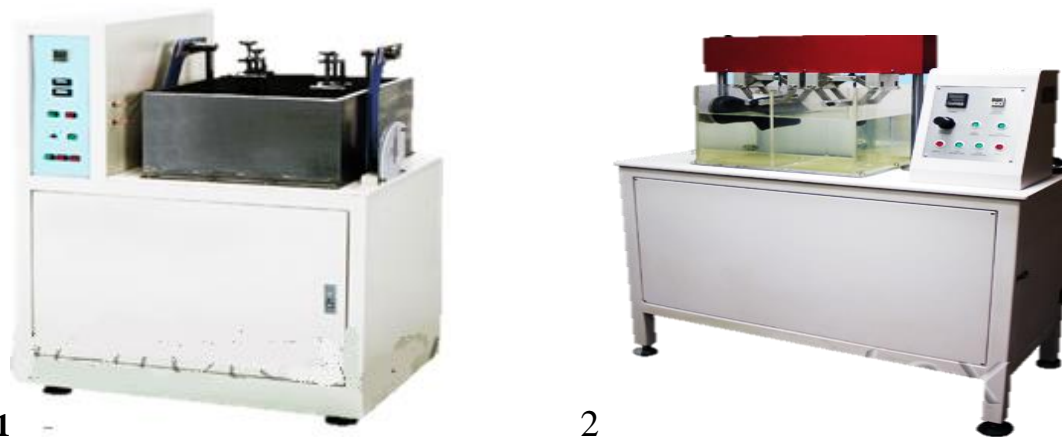
Рисунок 31.6 – Пристрої для визначення: 1 – водопроникності взуття в динамічних умовах (за ЕН ІСО 20344-2013 п. 5.15); 2 – водонепроникності гумового взуття (за ІСО 8782)
