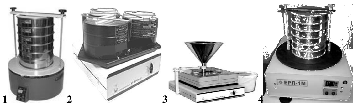
Рисунок 11.7 – Пристрої для визначення крупності помелу борошна: 1 – ситовий аналізатор А-12; 2 – розсів лабораторний тригніздовий У1-ЕРЛ-10-2; 3 – розсів лабораторний універсальний У1-ЕРЛ-10-3 (крім визначення крупності помелу визначає міру зараженості кошами і кліщами в явній формі та сорні домішки); 4 – розсів лабораторний ЕРЛ-1М
