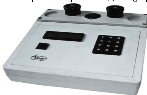
Рисунок 12.6 – Аналізатор кольоровості для цукру ЦУ ТЕП-С
