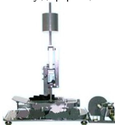
Рисунок 31.4– Пристрій для визначення загальної та залишкової деформації підноски та задника взуття (типу ЖНЗО-2)
