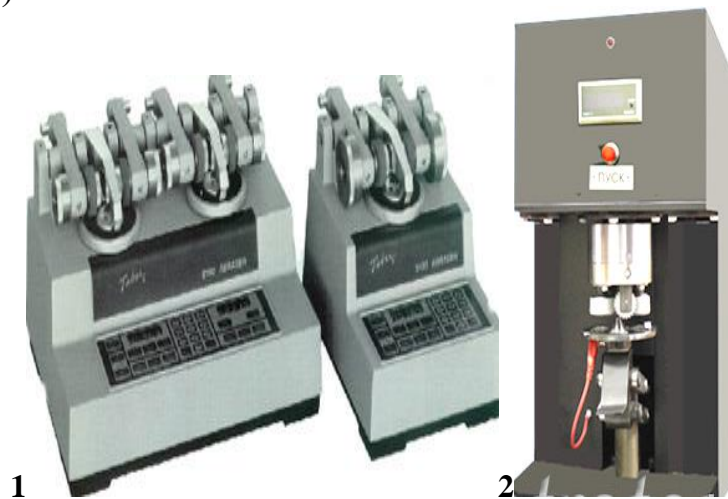
Рисунок 43.2–Прилади для визначення стійкості до сухого стирання:1 – абразиметр ТАБЕРА (Taber) для ротаційного стирання (модель 5135 на 2 зразки, модель 5155 на 1зразок);2 – випробувальний стенд МТ-194.1 (ДИТ-1)
