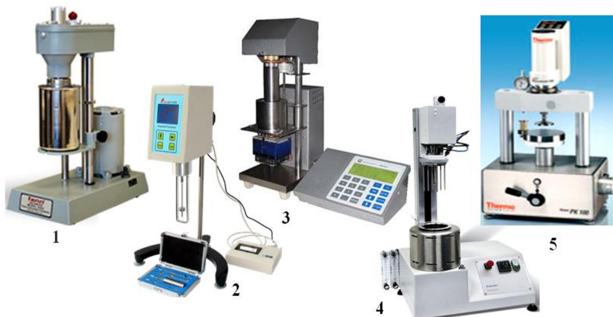
Рисунок 15.5 – Ротаційні віскозиметри: 1 – Fann 35; 2 – 1-51A; 3 – MCR-101; 4 – PEOTEST; 5 – PK100D
