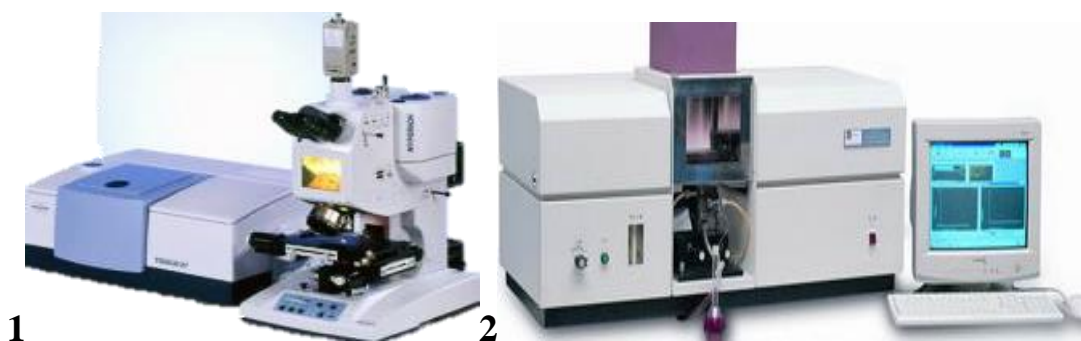
Рисунок 41.3– Спектрометри: 1 – Фурье-ІК спектрометр Bruker Vertex 70 (зразки вимірюються в кюветному відділенні або під мікроскопом); 2 – спектрометр атомної абсорбції WFX-110 (метод високотемпературного полум'яного спектрального аналізу атомної абсорбції)
