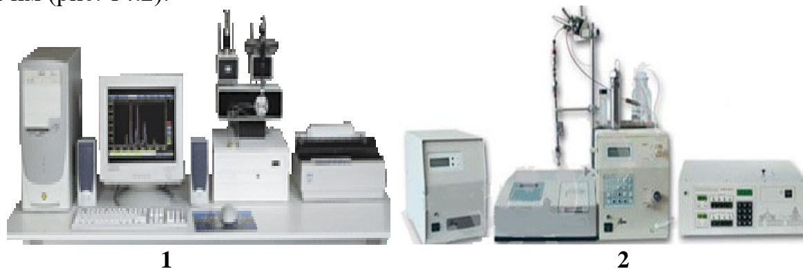
Рисунок 14.2 – Рідинні хроматографи: 1 – мікроколоночний рідинний хроматограф Міліхром-5; 2 – рідинний хроматограф ЛЮМАХРОМ
