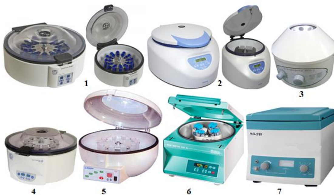
Рисунок 15.6 – Центрифуги лабораторні: 1 – Elmi CM-6MT; 2 – LMC-3000; 3 – 800-1; 4 – CM-6MT; 5 – CLMN-R10-01-Elecon; 6 – ROTOFIX 32 A; 7 – 80-2B
