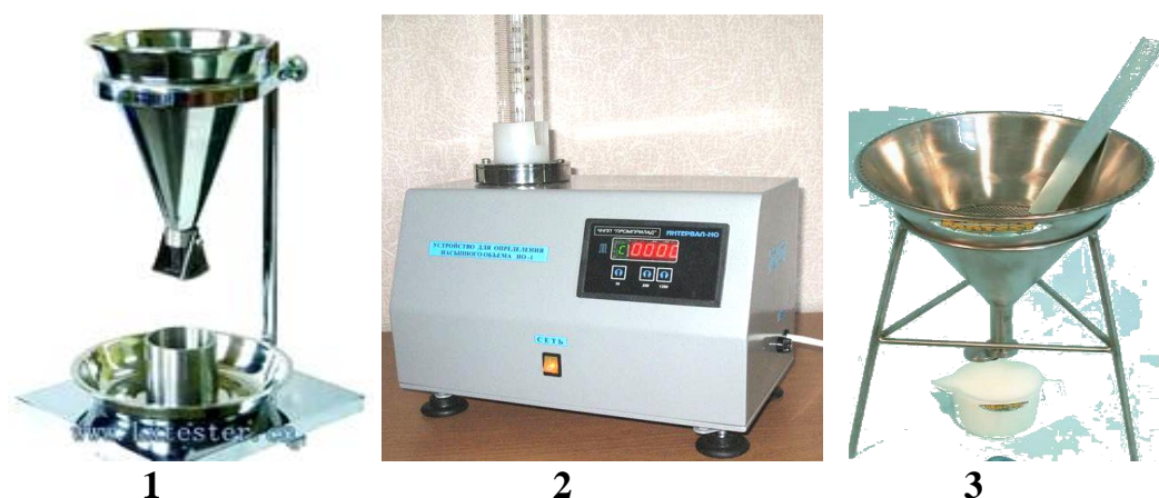
Рисунок 12.9 – Прилади для вимірювання насипної маси: 1 – аналізатор насипної маси GB 25571; 2 – прилад для вимірювання насипної маси ІКТЕРВАЛ-НО; 3 – аналізатор насипної маси E025
