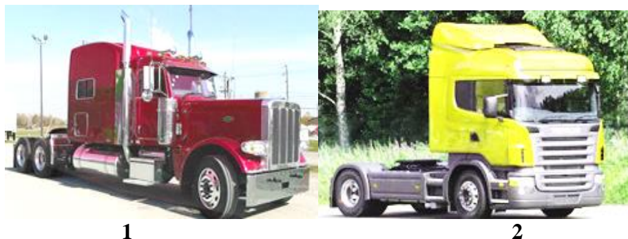
Рисунок 40.2– Зовнішній вигляд сідельних тягачів: 1 – «американський» тип; 2 – «європейський тип» (безкапотний автотягач)
