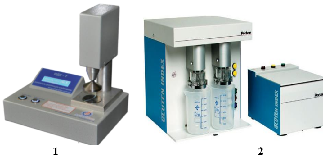
Рисунок 11.3 – Пристрої для визначення клейковини в пшеничному борошні: 1 – прилад для вимірювання деформації клейковини ИДК-7 (визначення якості клейковини); 2 – прилад Glutomatic 2100 (визначення кількості і якості клейковини)
