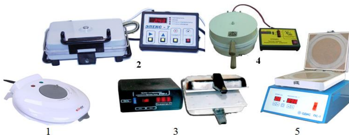
Рисунок 16.4 – Прилад Чижової: 1 – LivStar; 2 – Елекс-7; 3 – ВЧМ-А; 4 – ПМЧЦ модернізований; 5 – Одис ПС-1
