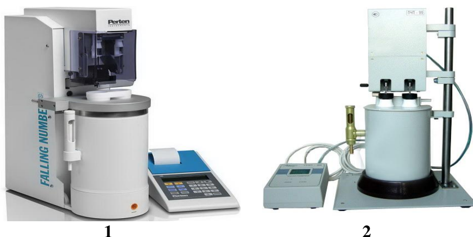
Рисунок 11.4 – Пристрої для визначення числа падіння в борошні: 1 – FallingNumber, Perten (за методом Пертена-Хагберга, вимірювання активності альфа-амілази, ICC 107/1, ААСС 56-81В, ISO 3093); 2 – прилад ПЧП-99-2К
