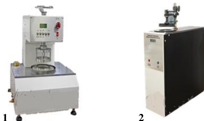
Рисунок 28.3 – Прилади для вимірювання гігієнічних властивостей тканин: 1 – вимірник водонепроникності текстильних матеріалів за ІСО 811-81; 2 – прилад для вимірювання повітропроникності текстильних матеріалів за ІСО 9237-99 (типу ВПТМ)
