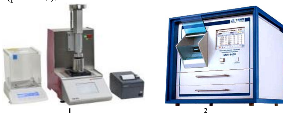
Рисунок 14.9 – Вимірювальні пристрої для автоматичного визначення в сигарет і сигар: 1 – щільності наповнення, а також твердості сигарет і фільтрувальних стержнів – D61A2; 2 – щільності та вологості – TSNC MW-4420
