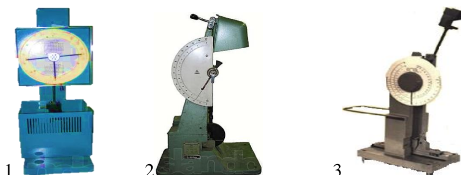
Рисунок 42.2– Копер маятниковий: 1 – тип МК-0,5; 2 – тип 2083 КМ-0,4; 3 – тип ИО 5138-0,5
