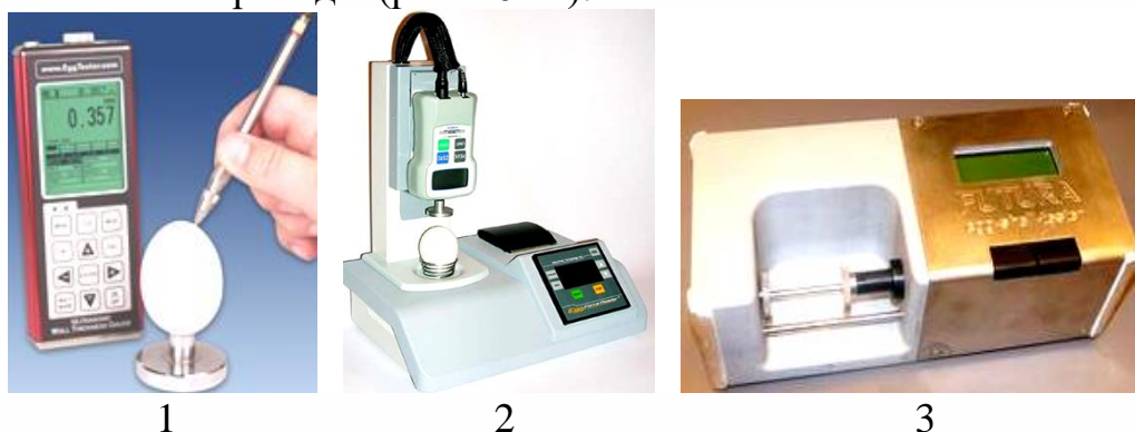
Рисунок 16.11 – 1 – Товщиномір шкаралупи яйця Orka; Міцностномір шкаралупи яйця: 2 – Orka; 3 – Futura
