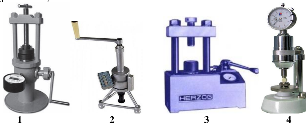
Рисунок 12.10 – Преси для вимірювання міцності цукру: 1 – прес ручний гідравлічний ПРГ; 2 – вимірник міцності ПОС-50МГ4.П; 3 – прес ручний гідравлічний Herzog; 4 – лабораторний тестер міцності Laberum
