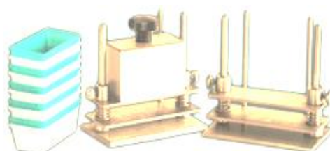
Рисунок 28.6 – Прилади для випробування стійкості забарвлення тканини: а – до тертя (типу ПТ-4): зліва – загальний вигляд, праворуч – підготовлений до досліджень; б – до дистильованої води, поту, морської води
