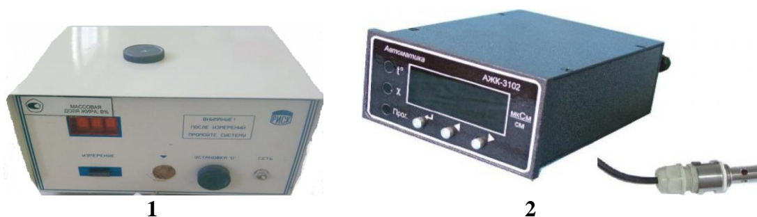
Рисунок 16.3 – Аналізатор - визначник жирності молока: 1 – ЖИР-1; 2 – АЖК-3102
