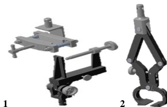
Рисунок 31.5 – Пристосування для визначення міцності кріплення підошов: 1 – у взутті хімічних методів кріплення; 2 – цвяхового, гвинтового, дерев'яно-шпилькового, пошивного кріплень
