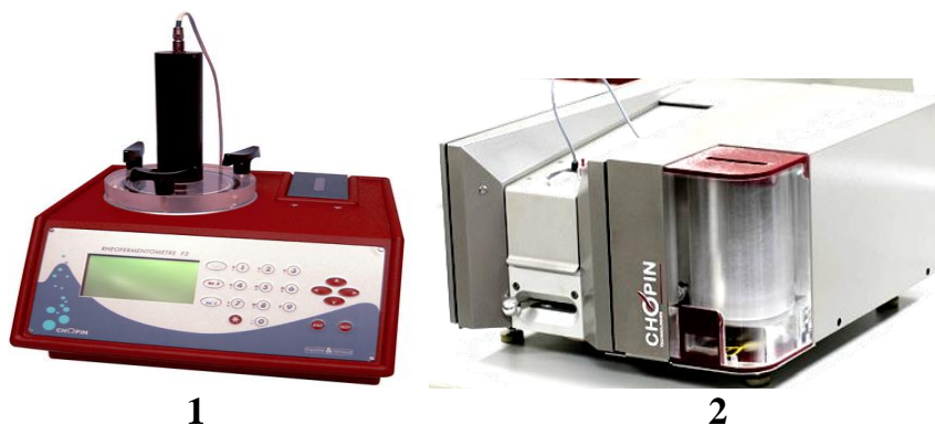
Рисунок 11.5 – Пристрої для визначення газотвірної здатності борошна: 1 – реоферментометр ФЗ; 2 – прилад Mixolab
