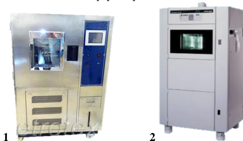
Рисунок 43.3– Прилади для випробувань стійкості до світла і світлопогоди (xenotest): 1 – ксенотест МТ-611, 2 – ксенотест Альфа М237Х
