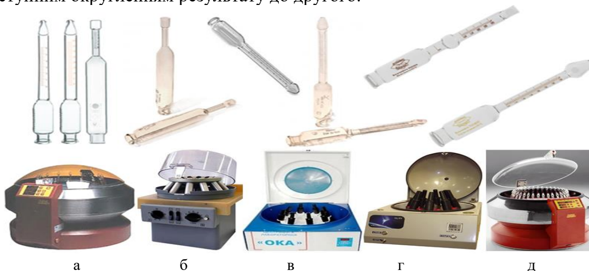
Рисунок 15.4 – Лабораторні бутирометри та центрифуги для бутирометрів: а – MPW-351e; б – ОПН-8; в – «ОКА»; г – «Комета»; д – SuperVario-N
