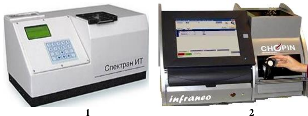
Рисунок 11.9 – Прилади для комплексного вимірювання показників якості борошна (за методом поглинання ІЧ випромінювання): 1 – ІЧ-аналізатор Спектран-119М (визначення вологості, кількості білка, клейковини, зольності); 2 – експрес-аналізатор INFRANEO (визначення кількості білка, вологості, хлібопекарської сила, клейковини, зольності)
