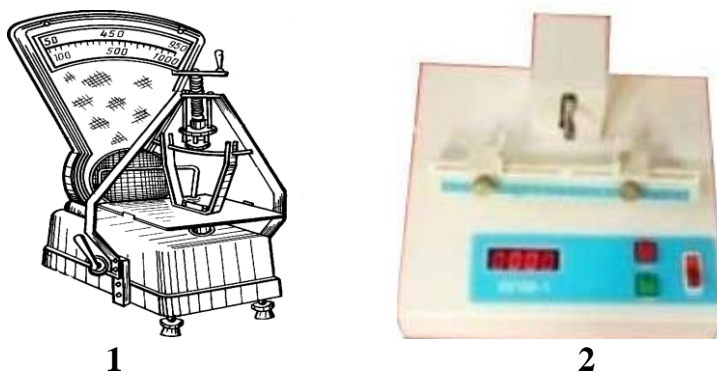
Рисунок 11.10 – Прилади для вимірювання міцності макаронів: 1 – прилад Строганова; 2 – ІМП-1 (аналог приладу Строганова)
