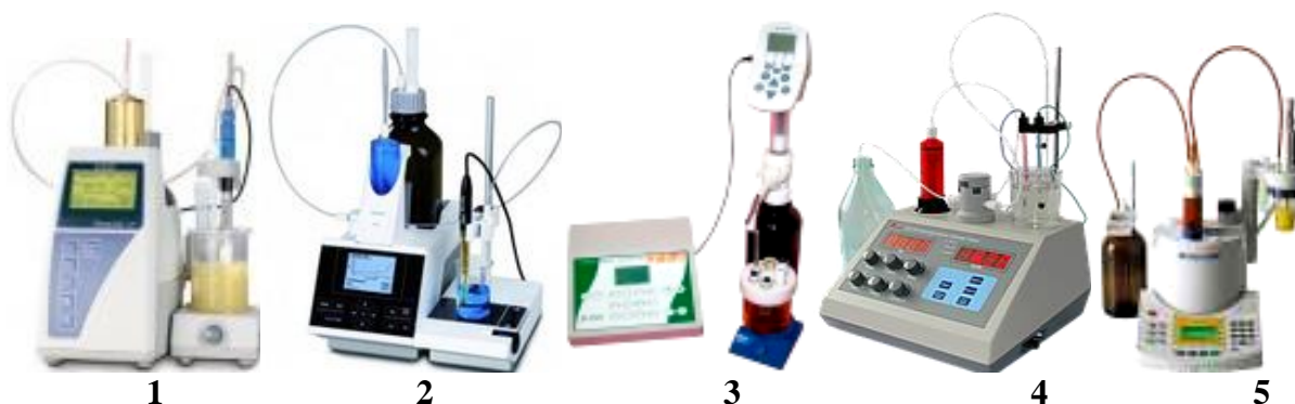
Рисунок 16.2 – Аналізатор потенціометр із блоком для автоматичного титрування: 1 – TL easy-III; 2 – експерт-007MB; 3 – TL 6000-M1/20; 4 – ZD-3A; 5 – DL22
