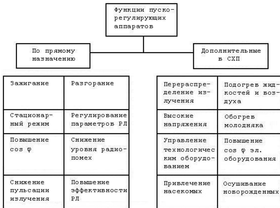
Рисунок 6.5 - Основные и новые (дополнительные) функции пускорегулирующих аппаратов для газоразрядных ламп, установленных в процессе работы
