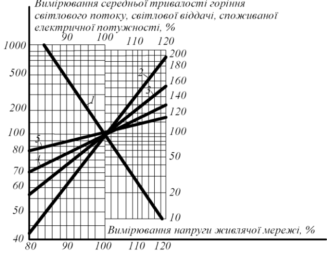
Рисунок 1.4.4 – Залежність світлотехнічних, електричних і експлуатаційних параметрів ламп розжарювання загального призначення від зміни напруги живлячої мережі:
