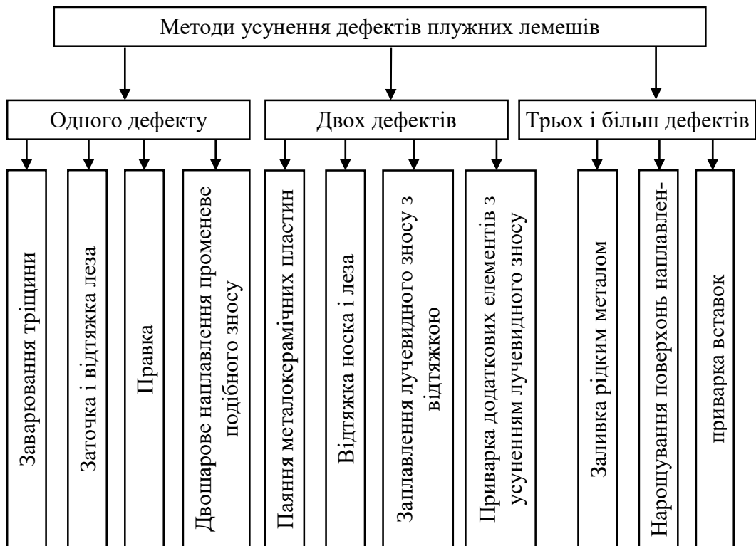
Рис. 2 – Методи усунення дефектів плужних лемешів
