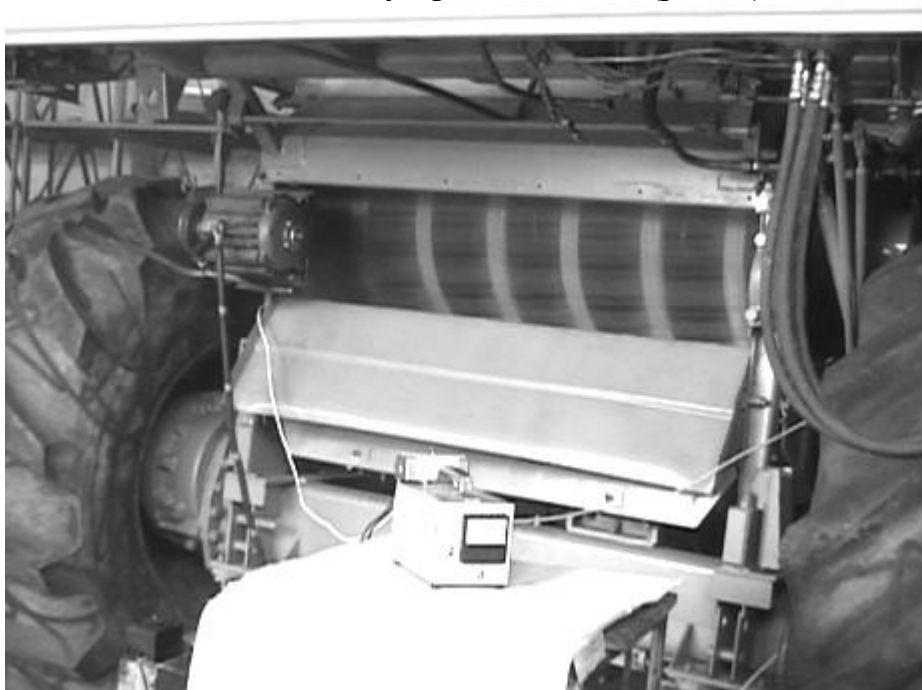
Рис. 9 – Розташування приладу ДБ-2К та електродвигуна під час балансування
