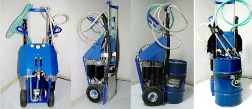
Рис. Д.6 Мобільна установка (станція) для заправлення та фільтрування гідравлічного масла КИ-28386.50
