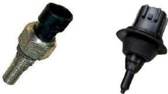
Рис.7 Зовнішній вигляд датчика температури охолоджуючої рідини (ліворуч) і датчика температури повітря у впускному тракті (праворуч)
