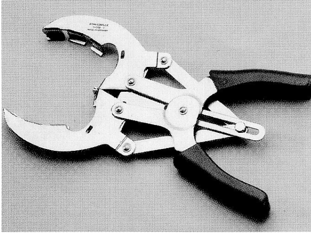
Рис. А.6 Пристрій для встановлення поршневих кілець КС 50 009 829 (монтажний діаметр 60 \div 160 мм)
