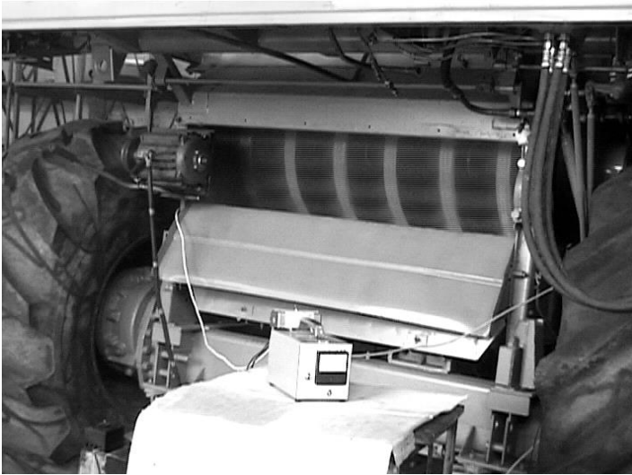
Рис. 2 Розташування приладу ДБ-2К та електродвигуна при балансуванні
