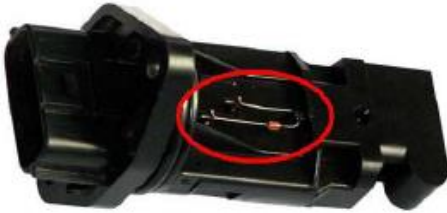
Рис.9 Зовнішній вигляд датчика температури повітря у впускному тракті на основі PN-переходу (датчик температури вбудований в корпус датчика масового витрати повітря BOSCH HFM5)
