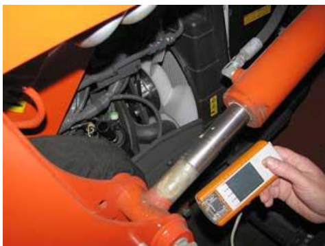
Рис. Д.7 Пристрій експрес-діагностування гідросистем навісних робочих органів сільськогосподарських машин КИ-28297 ГОСНИТИ
