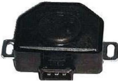
Рис. 20 Датчик крайніх положень дросельної заслінки, вимірювальними елементами якого є два мікрореле
