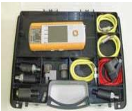
Рис. Д.7 Пристрій експрес-діагностування гідросистем навісних робочих органів сільськогосподарських машин КИ-28297 ГОСНИТИ
