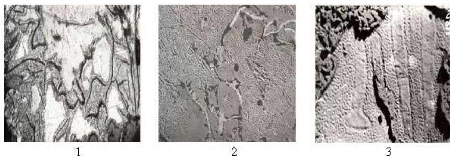
Рис.6.4. Оптическая микроструктура серого феррито-перлитного чугуна: литое состояние – фото 1, ×500; после пластической деформации – 2,×200; 3,×1000.
