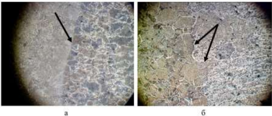
Рисунок 5.5 – Формування перехідної зони при наплавленні деталей зі сталі традиційним методом а); та при модифікуванні наноалмазами б), \times 100
