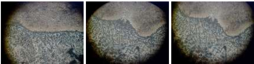
Рисунок 5.9 – Структура металу зон сплавлення при дозованому введенні модифікатора, \times 100
