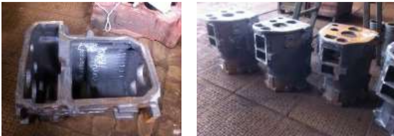
Рисунок 2.1 – Зовнішній вигляд корпусних деталей із сірого чавуну шляхом їхнього зачищення і наступної заварки сталевим електродом [159].
