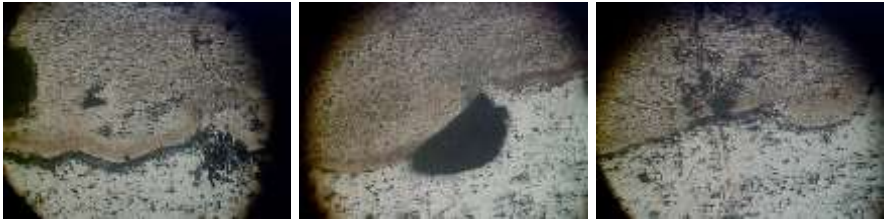
Рисунок 5.12 – Структура металу зони наплавлення при введенні модифікуючої домішки у вигляді шлікерного покриття, \times 100
