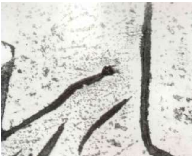
Рисунок 4.1 – Вихідна мікроструктура \times 100 . Вакуумне травлення
