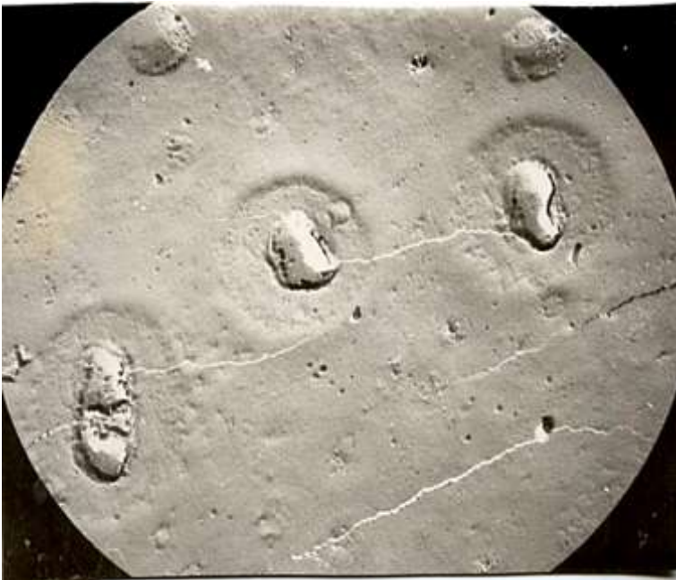
Рисунок 4.4 – Дислокації (ямки травлення з декоруванням вуглецем), що формують сітки. Вакуумне травлення, \times 11600
