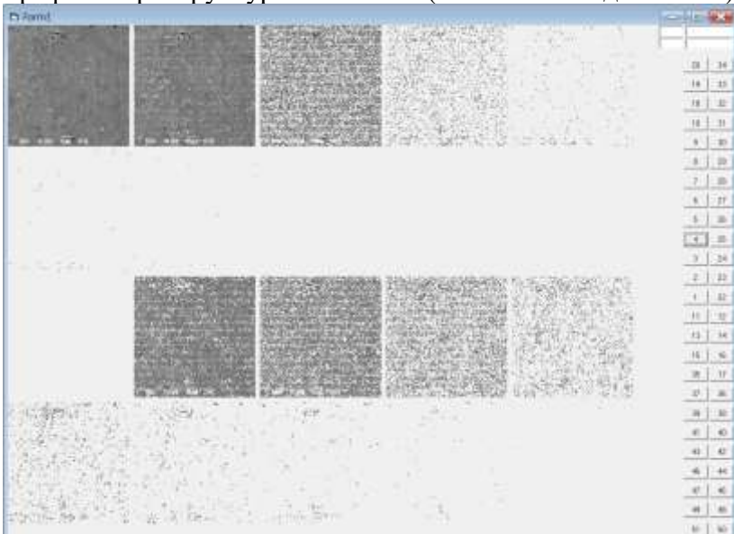
Рисунок 4.22 – Оптико-математична обробка електронних фотографій мікроструктур 4×5 пікселі (Фото 2 – наплавлення з модифікуванням шлікерним покриттям)
