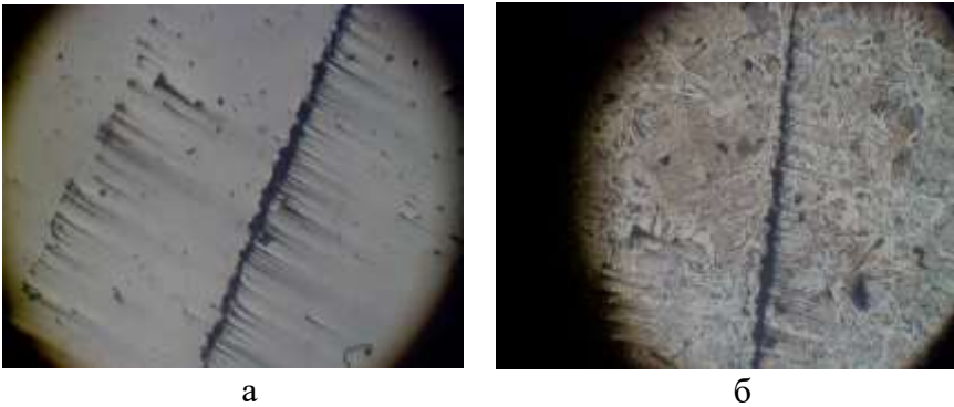
Рисунок 5.6 – Перевищена доля модифікатора з наноалмазами, \times 100
