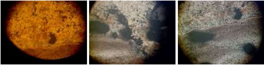
Рисунок 5.11 – Дефекти, що формуються при наплавленні без модифікуючої домішки \times 100
