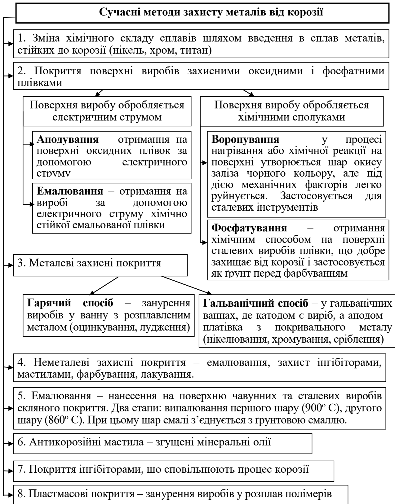
Рисунок 1.58 – Сучасні методи захисту металів від корозії
