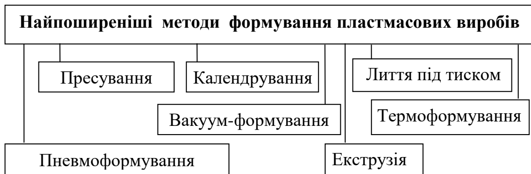
Рисунок 1.7 – Методи формування пластмасових виробів
