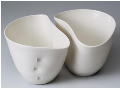
Рисунок 1. 44 – Приклад вигляду дефекту «пузири»
