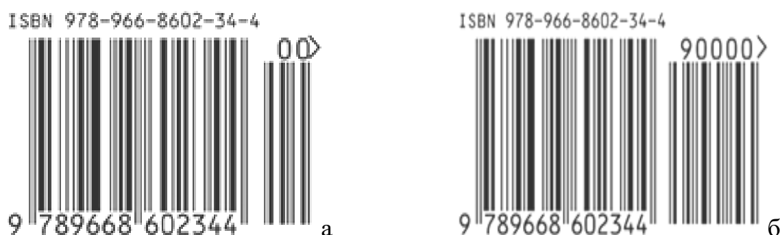
Рисунок 3.38 – Приклади штрихових кодів з «розширенням»: а) 2-х розрядна версія; б) 5-ти розрядна версія
