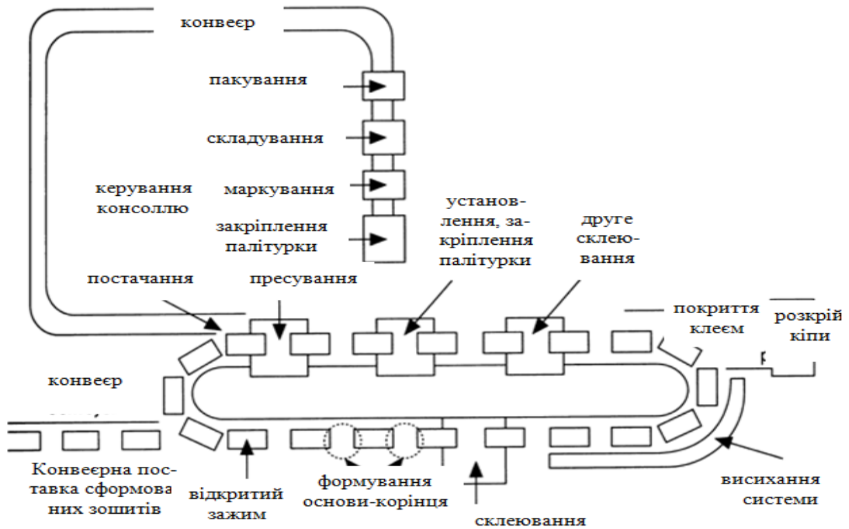
Рисунок 3.20 – Схема процесу виготовлення книжкових видань в обкладинці клейовим безшвейним скріпленням
