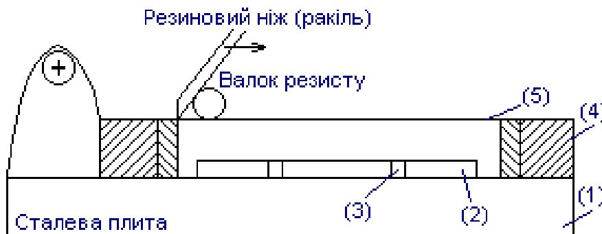
Рисунок 3.6 – Принцип шовкографічної технології друку
