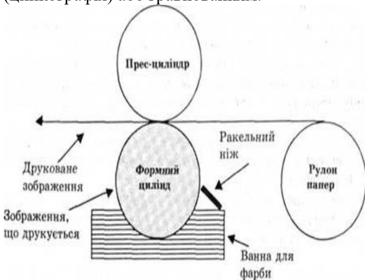
Рисунок 3.7 – Принцип технології високого друку
