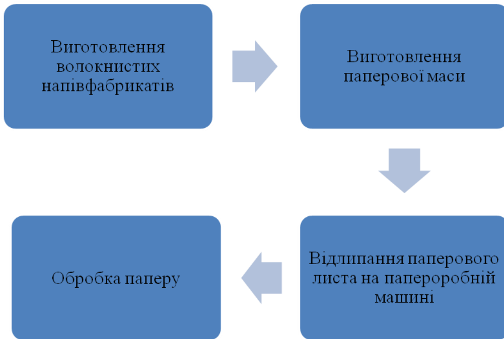
Рисунок 3.1 – Етапи виробництва паперу
