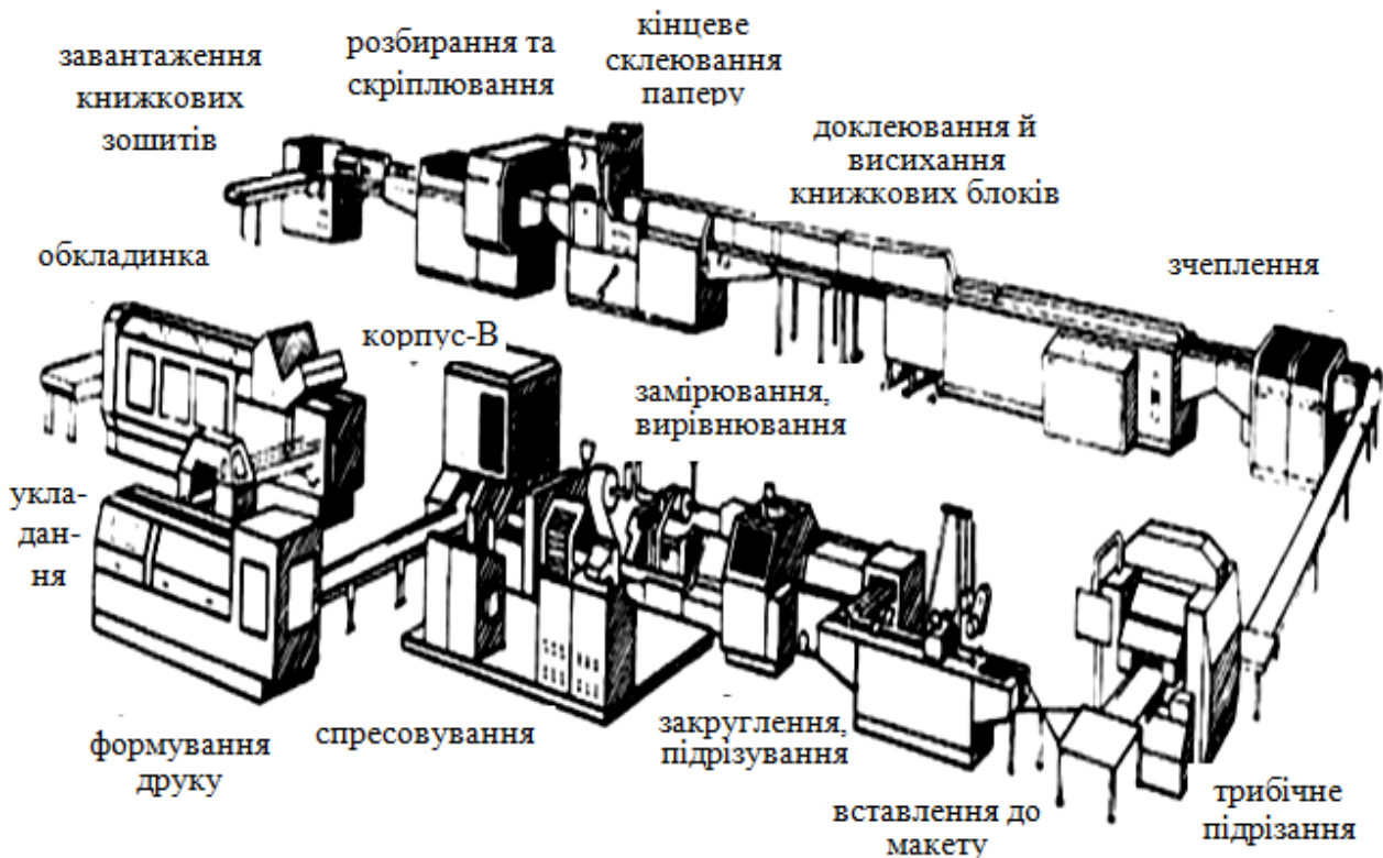
Рисунок 3.23 – Поточкова лінія з виробництва видань в палітурній кришці, скріплених потетрадно нитками
