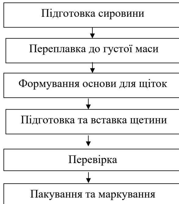
Рис. 5.3. Технологія виробництва зубних щіток
