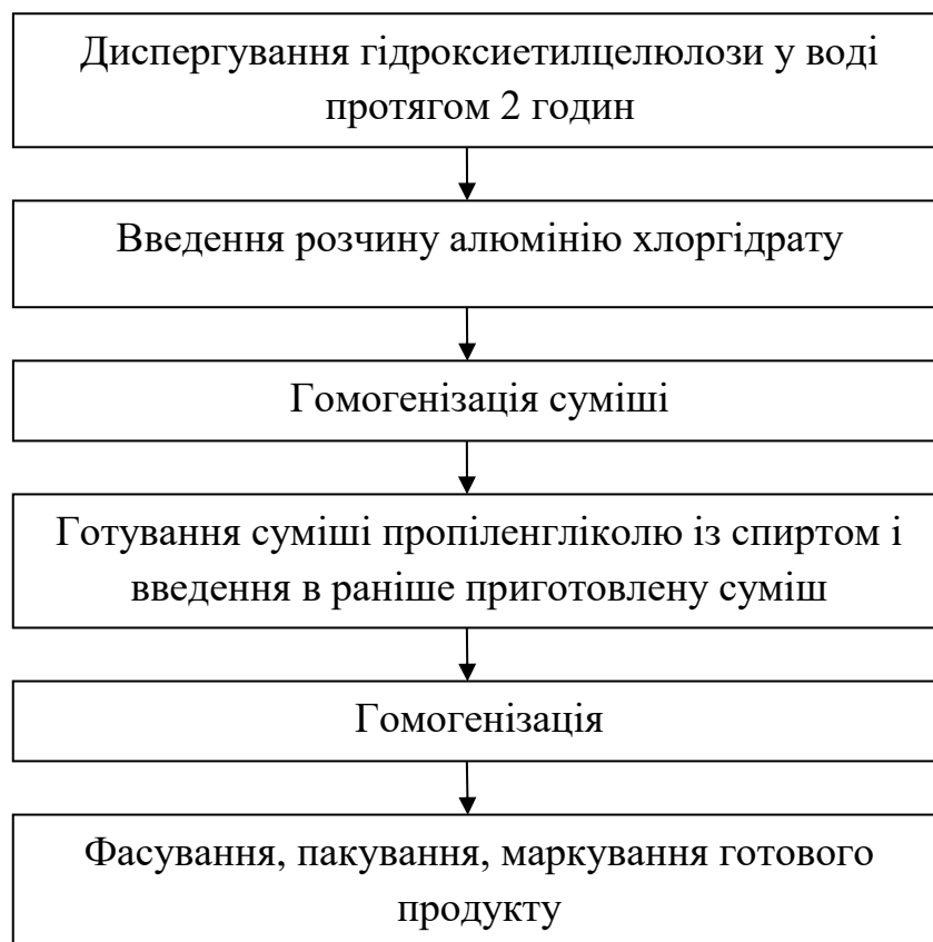
Рис. 9.1. Технологічна схема виробництва дезодоруючого засобу у кульковому упакованні
