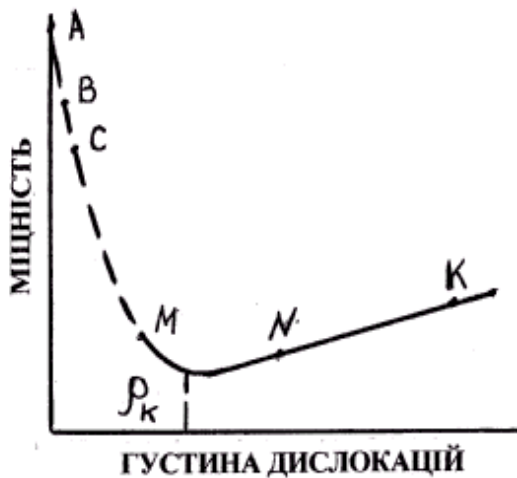
Рисунок 7.7 – Схема залежності міцності металів від густини дислокацій
