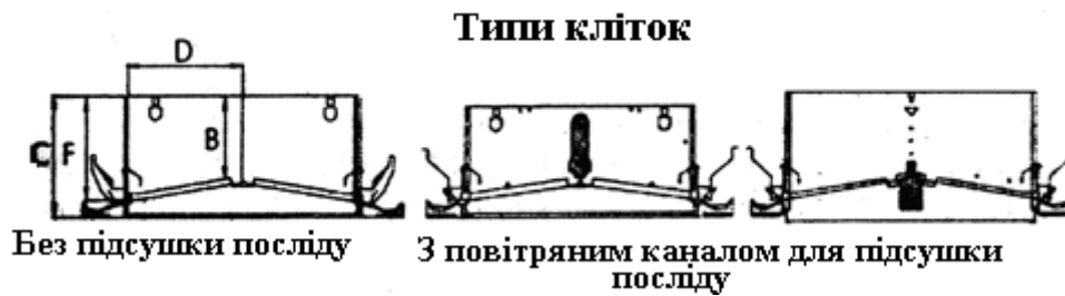
Рисунок 15.10 - Типи кліток кліткових батарей для утримання курок-несучок, що випускаються фірмою "Farmer Automatic"
