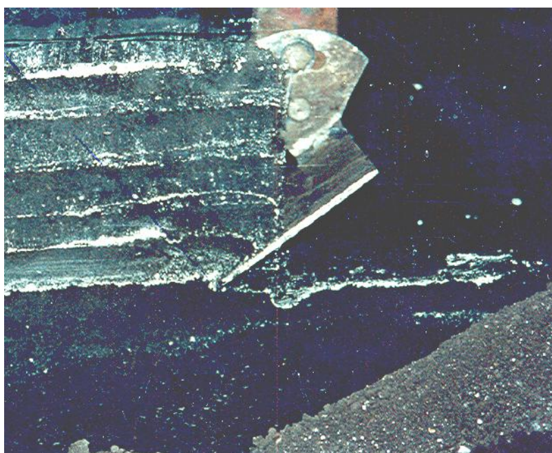
Рис. 4.5. Схема положения клина перед началом проведения эксперимента
