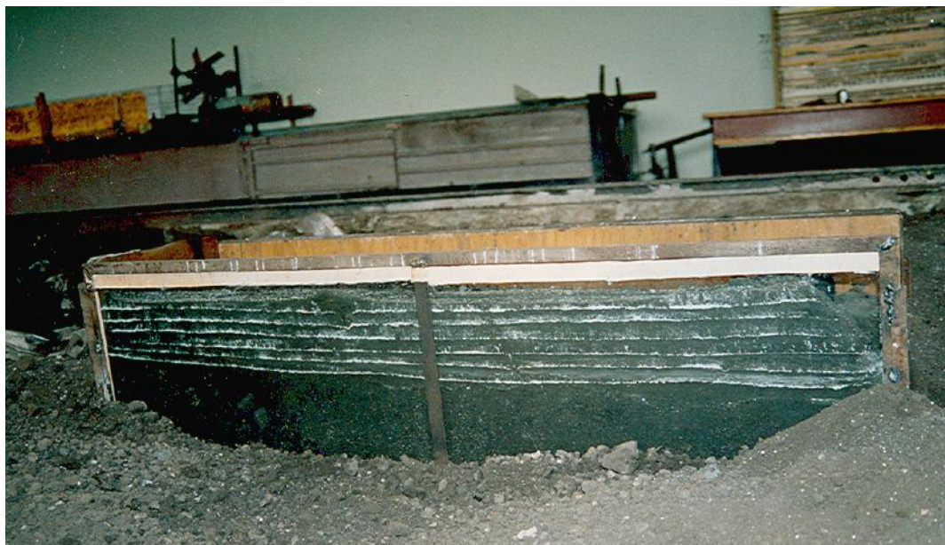
Рис. 4.2. Стенд для изучения процесса взаимодействия клина с почвой
