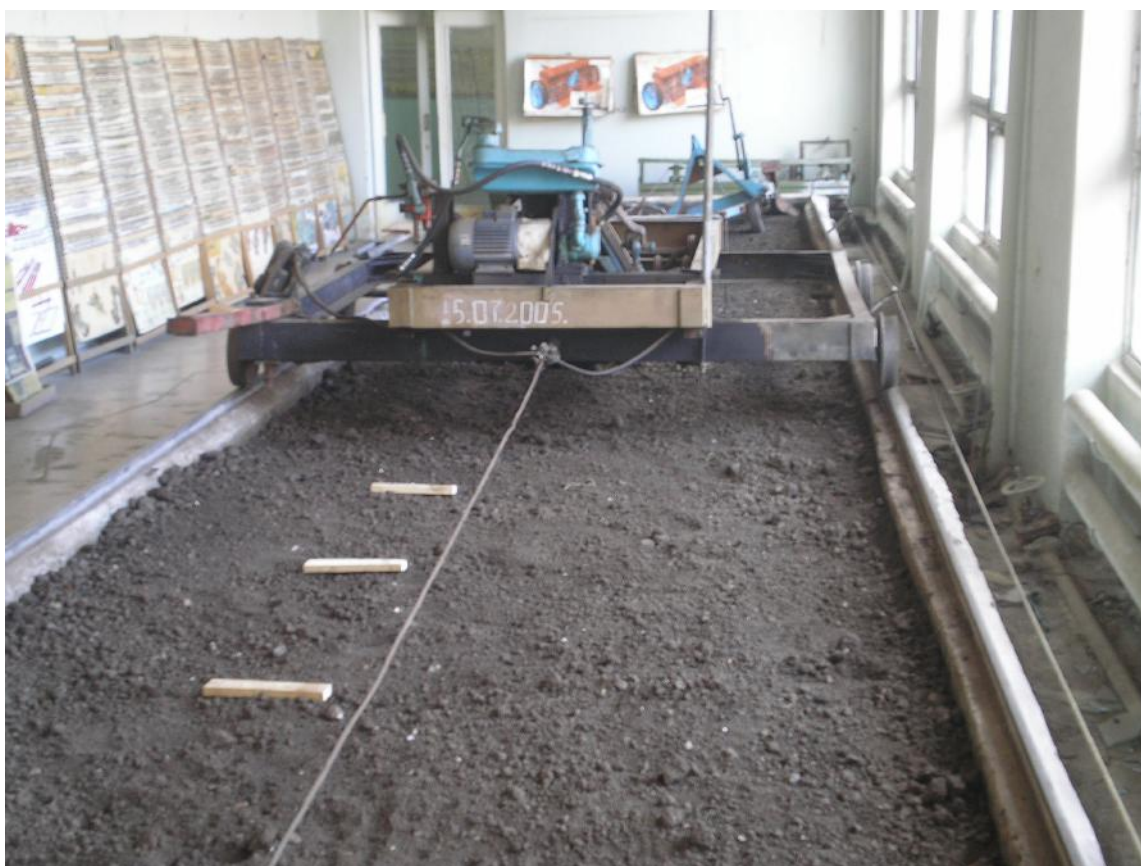
Рис. 4.4. Подготовка почвенного канала для проведения исследований на устойчивость сошниковой системы
