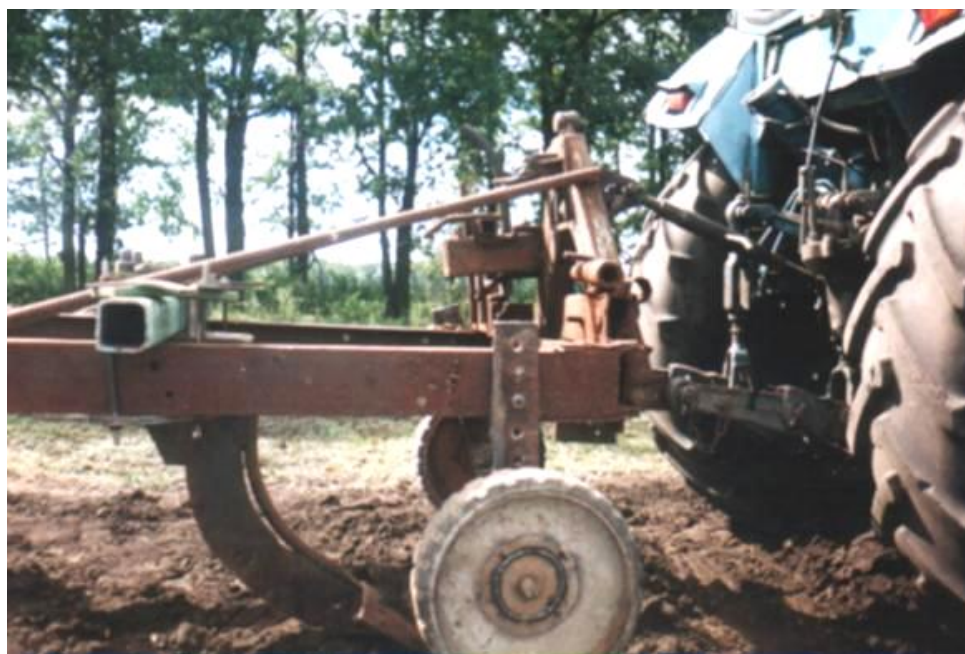
Рис. 4.6. Лабораторно-полевая установка для изучения процесса взаимодействия с почвой чизельных рабочих органов
