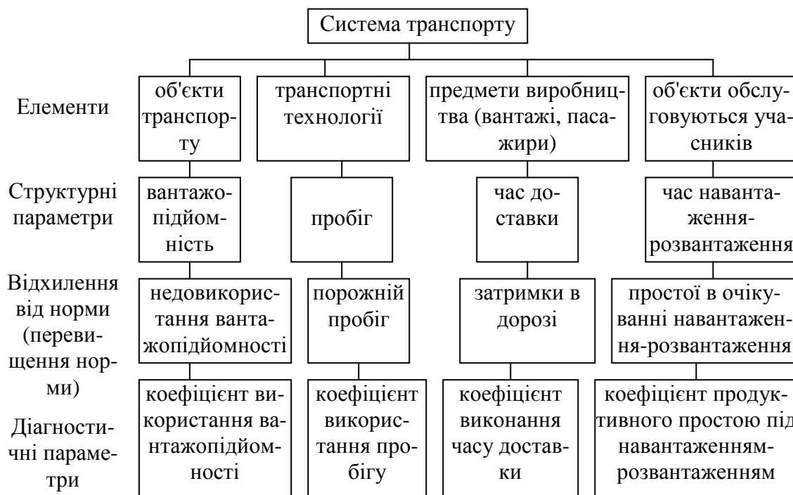
Рис. 4.15 – Структурна схема системи транспорту як об'єкта діагностування (приклад) (пропонується на підставі [33, с.203; 34, с.153; 35; 36])
