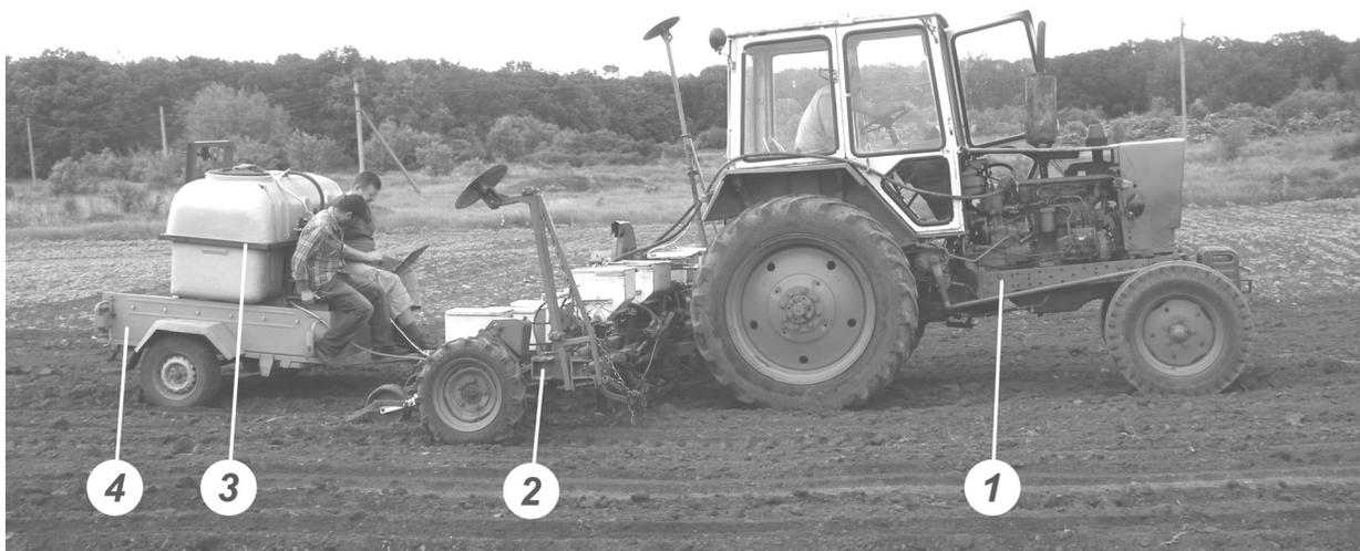
Рис. 3.15. Комбинированный МТА для посева пропашных культур с ленточным ВВГ на основе трактора класической компоновки ЮМЗ-6ЛС (1), сеялки СУПН-6А (2), серийног штангового опрыскивателя ОПНШ-800-14 (3) и легкового автомобильного прицепа (4)
