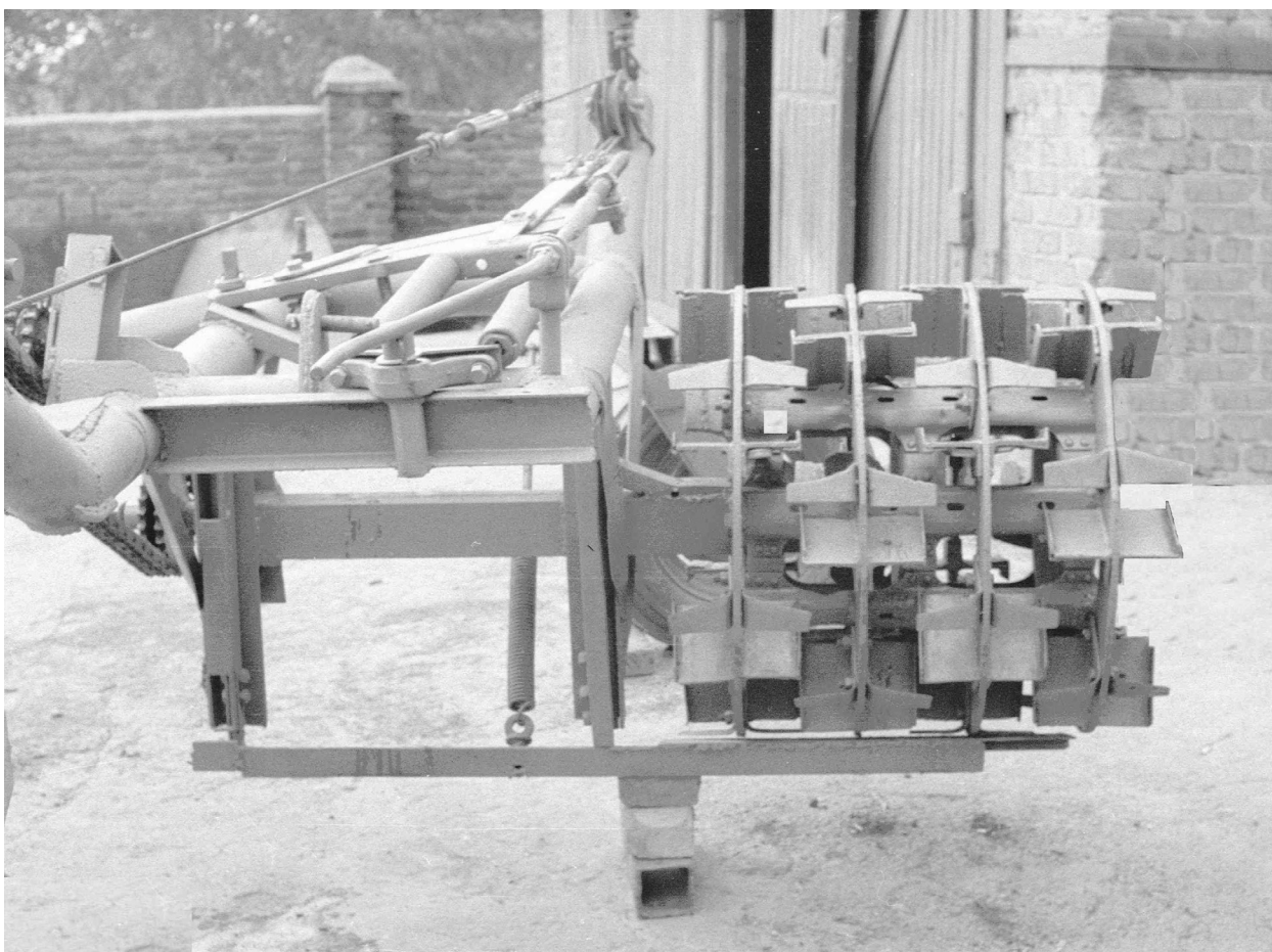
Рис. 3.15. Общий вид рабочего органа барабанного типа
