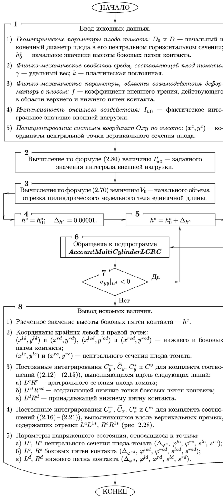
Рис. 2.29. Алгоритм расчета геометрии свободного контура и некоторых параметров напряженного состояния плода томата (изначально цилиндрического модельного тела бесконечной длины), находящегося в окружении других таких же плодов
