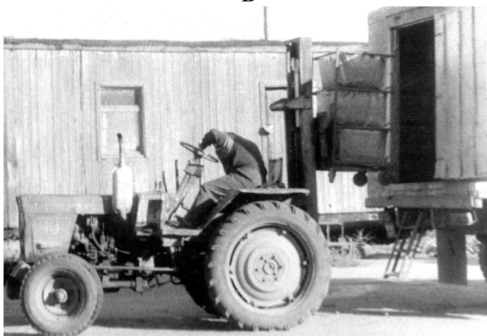
Рис. 5.1 Многоярусный контейнер в производственном участии: А, Б — контейнер в процессе транспортирования; В — погрузка контейнера в транспортное средство
