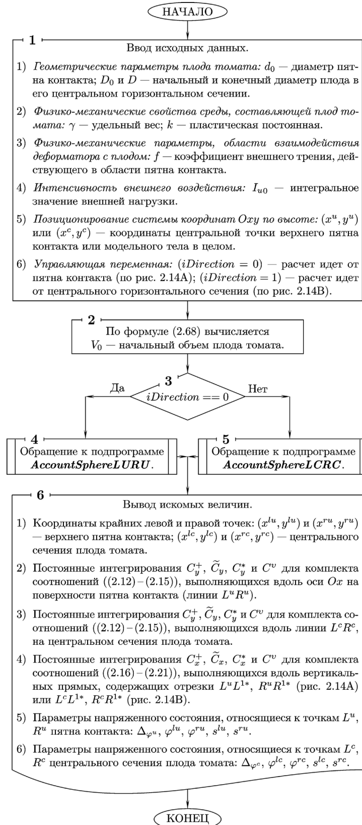
Рис. 2.15. Алгоритм расчета геометрии свободного контура и некоторых параметров напряженного состояния плода томата, как изначально сферического модельного тела
