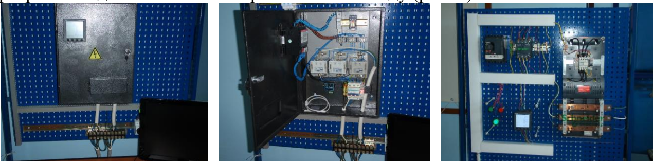
Рисунок 7 – Стенд для вимірювання вищих гармонік в мережі живлення частотно-регульованого електроприводу
